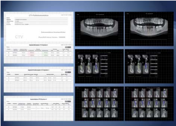
Abb. 8: Falldokumentation; Beispielfall Unterkiefer: Implantatlisten mit Positionsangaben; Bohrplan und dergleichen. Berechnete Übersichtsbilder mit einkonstruierten Implantaten und ggf. N. mandibularis; Schnittbildarstellungen; Darstellung Knochenlager +/- 3,5 mm von der Implantatachse.
