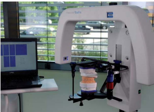
Abb. 12: Das Repositionsgerät kann anstelle des Patienten mit dem System gekoppelt werden.
