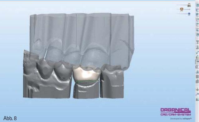
Abb. 5: Umwandlung des Datensatzes im Lab-Modus in die STL-Formatierung. – Abb. 6: Importieren der STL-Daten in das 3Shape-Modul. – Abb. 7: Konstruktion der Krone 36, Gestaltung der Kaufläche. – Abb. 8: Virtuelles Artikulieren der Kaufläche. Die Daten sind fertig für den Fräsprozess.
