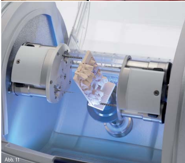
Abb. 9: Artikulieren der NEM-Krone auf dem SLA-Modell von infiniDent. – Abb. 10: Die ausgefräste, polierte NEM-Krone Regio 36 in situ. – Abb. 11: Das Arbeitsmodell für die Gerüstaufpassung kann alternativ zum SLA-Verfahren auch mit inLab MCXL im Labor ausgefräst werden.
