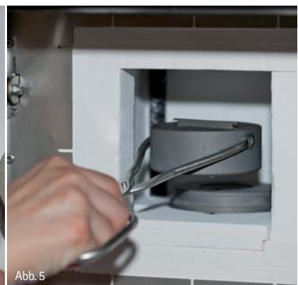
Abb. 3: Trockenfräsen der Restauration aus dem Ceramill Sintron®-Rohling auf der Ceramill Motion. – Abb. 4: Positionierung der Restauration in der Sinterschale von Ceramill Argovent – Sinterkammer des Schutzgas-Sinterofens Ceramill Argotherm. – Abb. 5: Einsetzen der Sinterschale in den Sinterofen mit aufgesetzter Sinterhaube.
