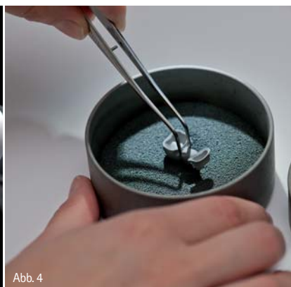
Abb. 3: Trockenfräsen der Restauration aus dem Ceramill Sintron®-Rohling auf der Ceramill Motion. – Abb. 4: Positionierung der Restauration in der Sinterschale von Ceramill Argovent – Sinterkammer des Schutzgas-Sinterofens Ceramill Argotherm. – Abb. 5: Einsetzen der Sinterschale in den Sinterofen mit aufgesetzter Sinterhaube.
