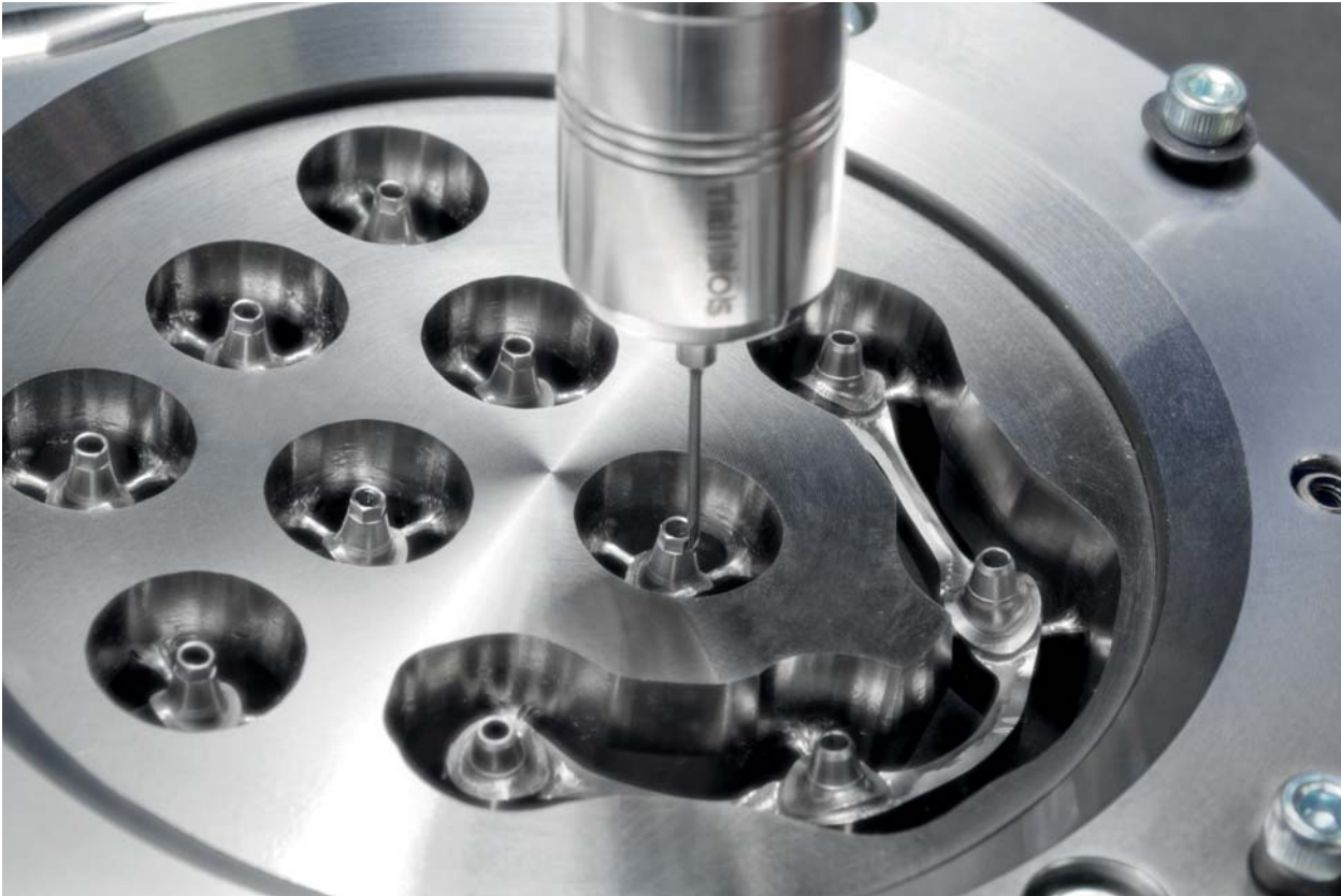
Abb. 2: 5-Achs-Simultanfräsen von Abutments und implantatgetragem Steg aus Titan.
