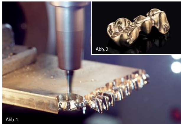
Abb. 1: Fräsen auf der 6-Achs-Maschine bei C. HAFNER. – Abb. 2: Dreigliedrige gefräste Brücke aus Edelmetall.
