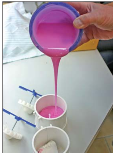
Abb. 2: Herstellung der Dublierform aus Silikon.
