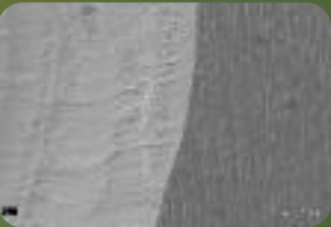
REM Aufnahmen (50-fache Vergrößerung) Die Oberfläche von Enamel plus Bio Function scheint natürlich und gleichmäßig abradert.
