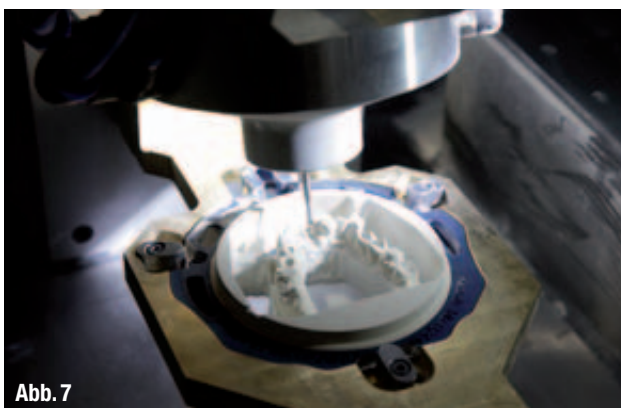
▲ Abb. 7: 5-Achs-Fräsmaschine zur rationellen Fertigung aller Materialien. ▲ Abb. 8: 3-D Kunststoffdrucker.
