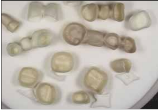
Abb. 11 Arbeiten für Datensatzanlieferer werden beim Dichtsintern mit unterschiedlich geformten Plättchen aus Zirkoniumdioxid markiert
