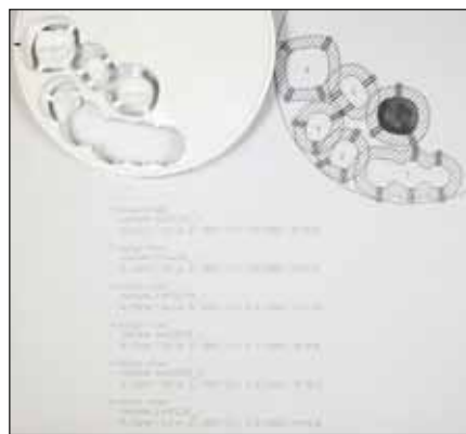
Abb. 10 Ist der Rohling gefräst, hilft der Rohlingsausdruck (CAM-Modul) dabei, den einzelnen Auftrag zu identifizieren
