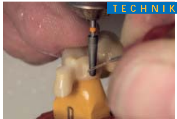
Abb. 10 Um energetisch indizierte Spannungen und Mikrorisse im Zirkondioxid und in der Aufbrennkeramik zu vermeiden, wird unter Wasserkühlung gefräst.
