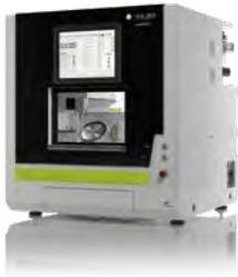
**cara Mill 3.5:** Bei cara Mill 3.5 mit ihren 6 mm-Schäften handelt es sich um eine stärkere und technisch ausgefeiltere Fräse. 5 Achsen mit einem Achs-Anstellwinkel bis 30°, die von Servomotoren reguliert werden, ermöglichen die simultane Werkstoffbearbeitung auf höchstem Niveau. Die 1KW-Spindel mit einer Maximaldrehzahl von 60.000 U/min. ist in der Lage, selbst harte Werkstoffe wie CoCr und Titan zu bearbeiten. Und dabei passt cara Mill 3.5 immer noch auf Ihren Arbeitstisch.
