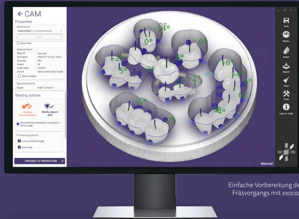
Einfache Vorbereitung des Fräsvorgangs mit *exocam*
