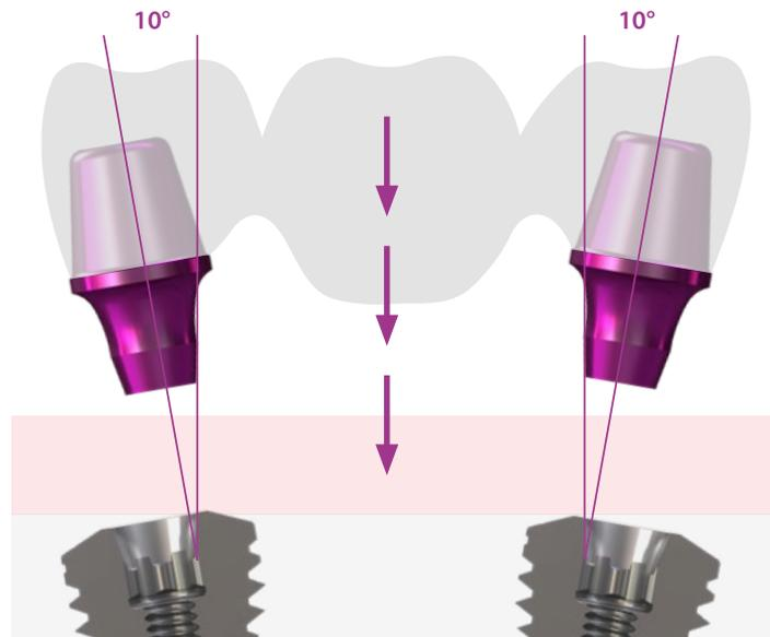
Die Konstruktion kann einfach eingegliedert und okkusal verschraubt werden. Der lange Konus leitet die lateralen und okklusalen Kräfte direkt in das Implantat und schützt damit die Schraube vor Lockerungen und Brüchen.
