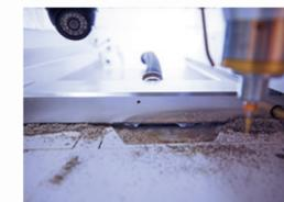
Wenn es auf Präzision und Geschwindigkeit ankommt, ist Sauberkeit ein entscheidender Faktor. Das vollautomatische Innenraum-Reinigungssystem Pi-Clean sorgt für die schnelle und gründliche Reinigung des Arbeitsraums. Außerdem dabei: Das vollautomatische Absaugsystem zur sicheren Entsorgung von Spänen und Staub. Ein Späne-Vorscheider mit Zyklonturbine komplettiert das System.
