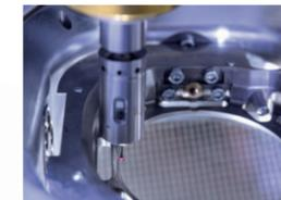
Hochpräziser Werkzeuglängen-Sensor zur Kalibrierung der Fräsmaschine und zum Einmessen von hybridgefertigten Lasersinter-Teilen. Formabweichungen werden bis zur perfekten Passung nachgefräst. Als integraler Bestandteil der Maschine eine Innovation in der Dentalbranche.
