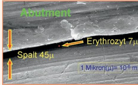
Spalt zwischen Abutment und Implantat
