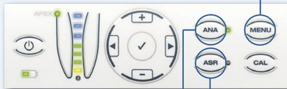
**ANA\*:** Reduktion der Drehmomentgrenze bei der Aufbereitung von Wurzelkanälen mit komplexer Anatomie
