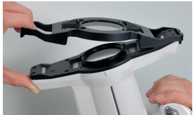
Mit aufgestecktem Kreuzpolarisationsfilter – kurz: Polfilter – zeigt die EyeSpecial C-V einen Blick ins Innere des Zahns: Chroma, interne Lichteffekte und individuelle Zahncharakteristika werden sichtbar, ohne dass durch den Schmelz erzeugte Lichtreflexionen diese verfälschen. Auch farbliche Effekte des Hart- und Weichgewebes lassen sich mit Polfilter besser beurteilen.
