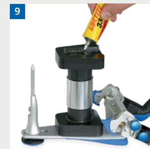
9 Splitexplatte mittig mit zwei Kleberspuren versehen
