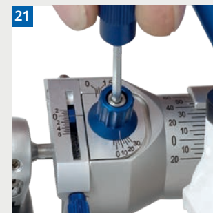
21 Öffnen der Sideshiftstellschraube, um die Immediale Sideshift (ISS) zu öffnen. Frontzahnführungsstift außer Kontakt stellen
