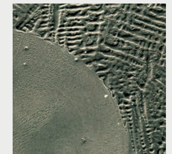
Rissfreie Lasernaht bei einer kohlenstofffreien CoCrMo-Modellguss-Legierung
