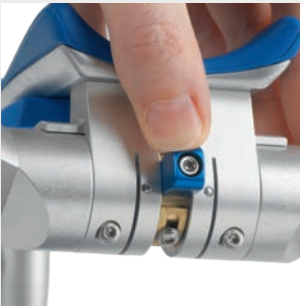
Die reproduzierbare Zentrik gewährleistet eine sichere Start- und Endposition jeder Bewegung. Störungen unter 20 µm können ertastet, kontrolliert und beseitigt werden.
