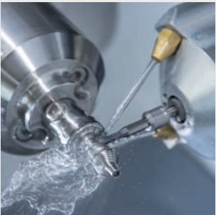
Nassbearbeitung eines Titanabutmentrohlings mit der Technik des „Rotationsfräsens“
