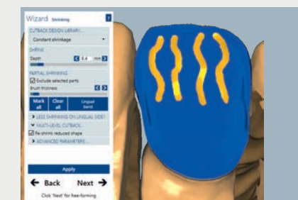
Schrumpfen ausgewählter Bereiche für individuelle keramische Verblendung
