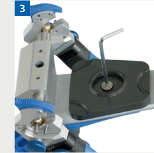
3 Splitex TOP-Platte im Artex-Oberteil festschrauben
