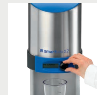
Ein Schalter für alles – multifunktionaler Dreh-/Drückknopf
