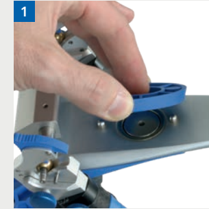
1 Modellplatte, Magnet und Magnetpotf aus Artex-Ober- und Unterteil entnehmen
