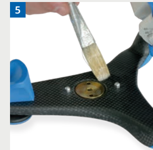
5 Carbonfläche im Bereich der Klebeplatte mit dünner Schicht Vaseline isolieren
