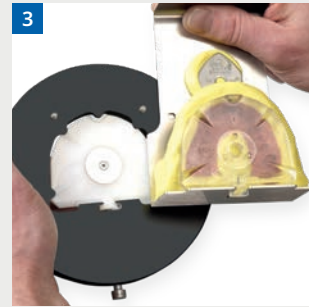
3 Giroform-Sockelplatte ist eingelegt. Der Abdruckträger wird auf die Plattenaufnahme aufgesetzt
