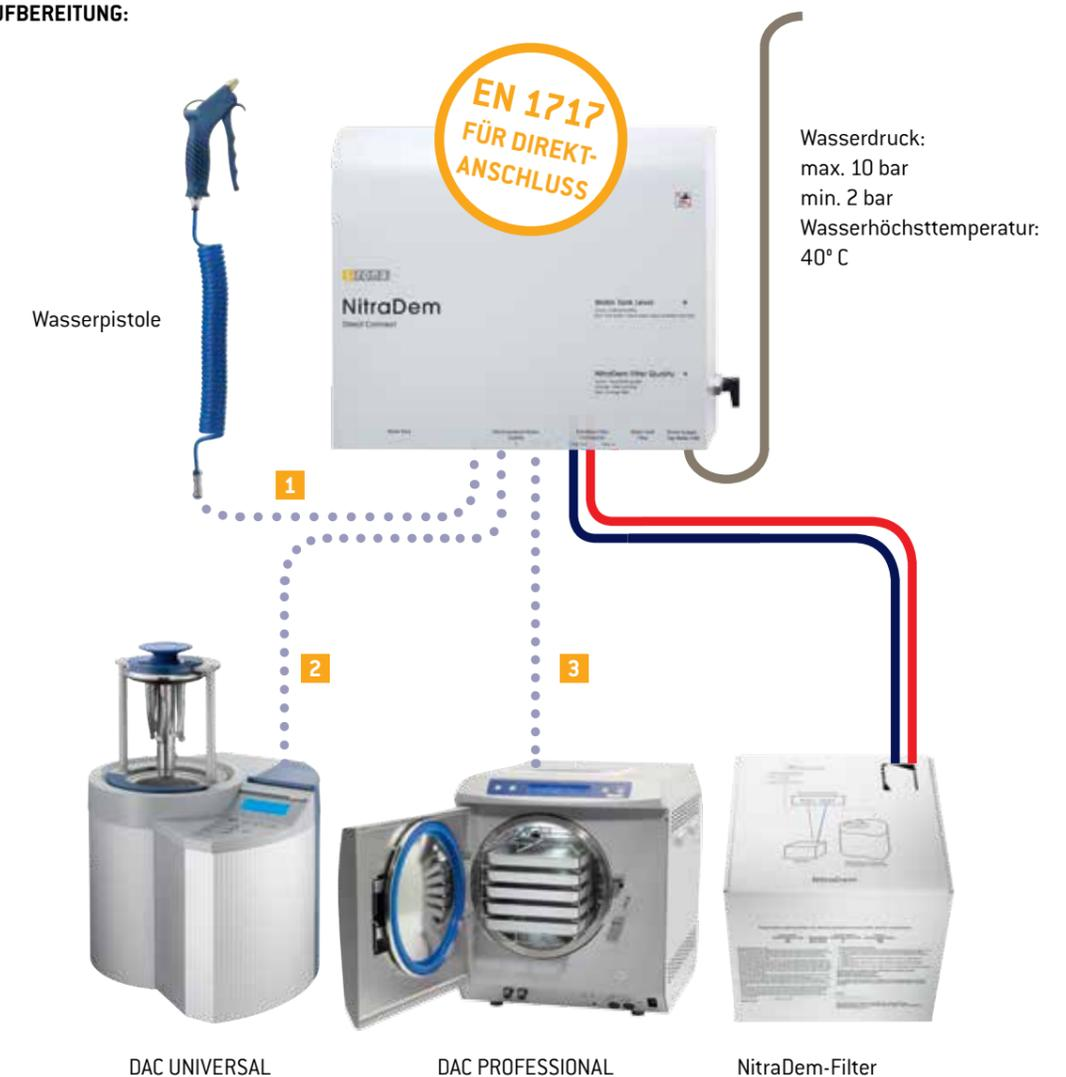
REF: 62 59 852 NitraDem Direct connect (mit Installationskit, NitraDem-Filter, Kontrollpanel)
